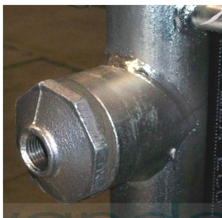
Siurblio recirkuliacijos sistemos ant siurblio išmetimo žarnos pavyzdys
