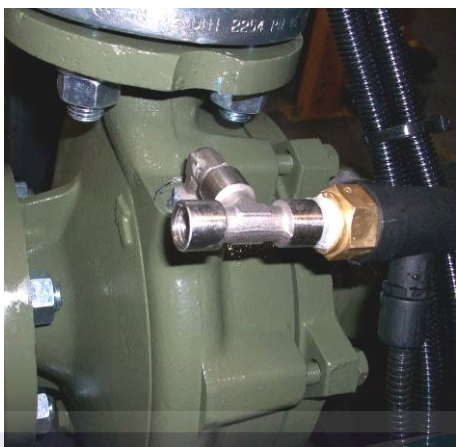
Siurblio recirkuliacijos sistemos ant siurblio korpuso pavyzdys
